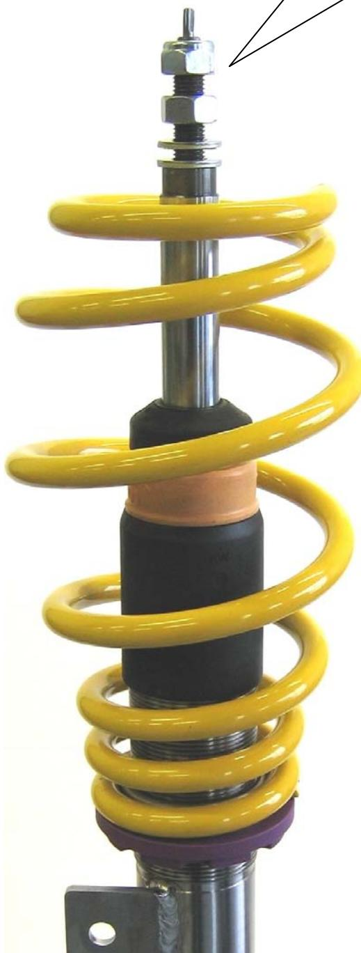
Original Stützlager aufstecken und mit der mitgelieferten Mutter und 2 Unterlegscheiben verschrauben. Zum verschrauben des Federbeins in das Fahrzeug, verwenden Sie bitte die mitgelieferte Stoppmutter. Das Anzugsdrehmoment der Kolbenstangenbefestigung beträgt 40 Nm. Die Montagehinweise zum Einbau des Federbeines in das Fahrzeug, sowie die Anzugsdrehmomente der Federbeinbefestigung, entnehmen Sie bitte den Unterlagen des Fahrzeugherrstellers.
